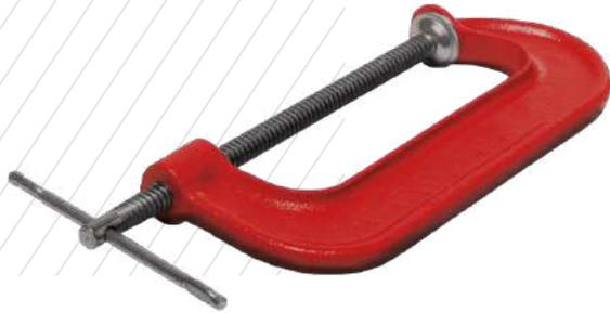
Fabricados para fixação rápida de peças e equipamentos permitindo aperto firme e seguro. Fuso em aço laminado com rosca trapezoidal com acabamento zincado bicromatizado e corpo em ferro fundido nodular FE 42012 com pintura a pó eletrostática.
